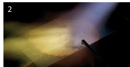
2 Конкурент - CuP сплав: искрится, плохая смачиваемость
