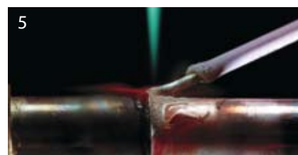
5 Чистое плавление покрытого флюсом прутка Castolin
