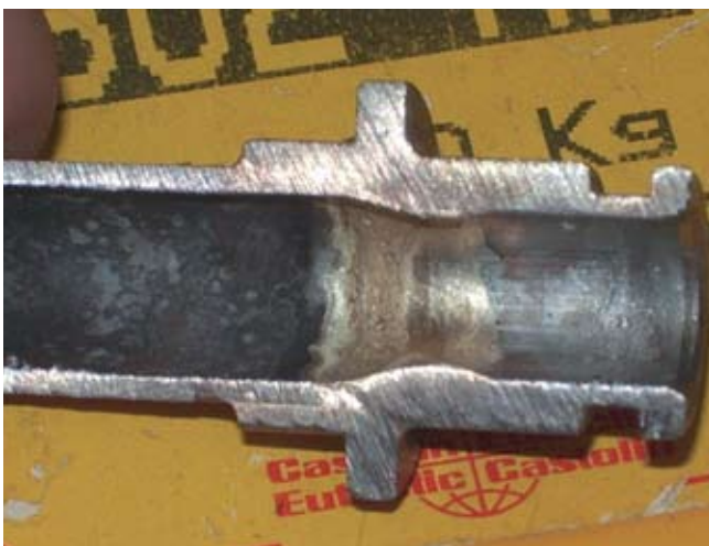
Отличное качество соединения даже в труднодоступном месте благодаря применению 1802 HF Atmosin.
