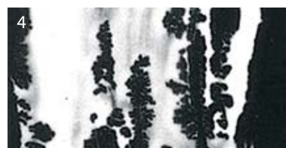
4 Флюс без компонента Atmosin: Плохая текучесть и смачиваемость
